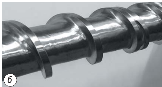
РИС. 5. Внешний вид сильно изношенного шнека до (а) и после (б) ремонта
