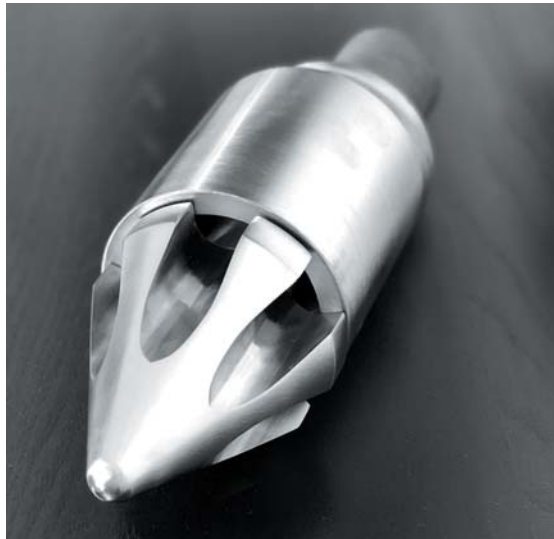
РИС. 3. Изготовленный по образцу наконечник шнека ТПА с новым запорным клапаном
