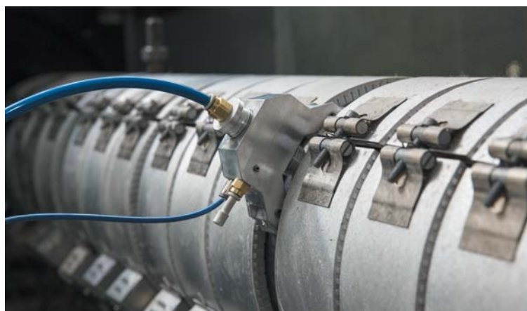
РИС. 1. УЗ-система мониторинга текущего состояния шнека, смонтированная на внешней стороне материального цилиндра (рис. 1 и фото у заголовка: ENGEL)
